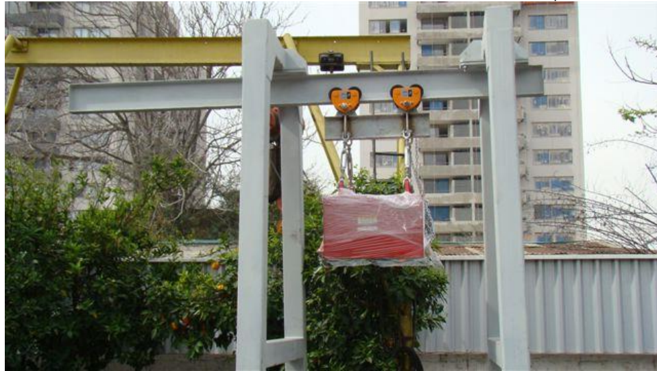
Magneto Suspendido Serie MAG, montado en su estructura parrón.
