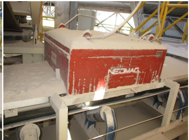
Magneto Suspendido Serie MAG, montado en su estructura parrón.
