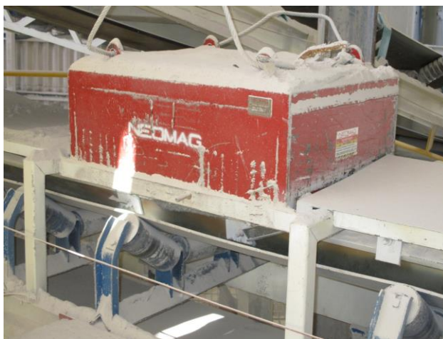
Magneto Suspendido Serie MAG, suministrados para Planta de Cal.
