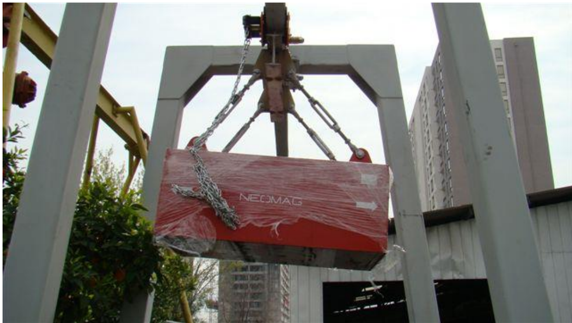
Magneto Suspendido Serie MAG, suministrado para Planta de Cal.
