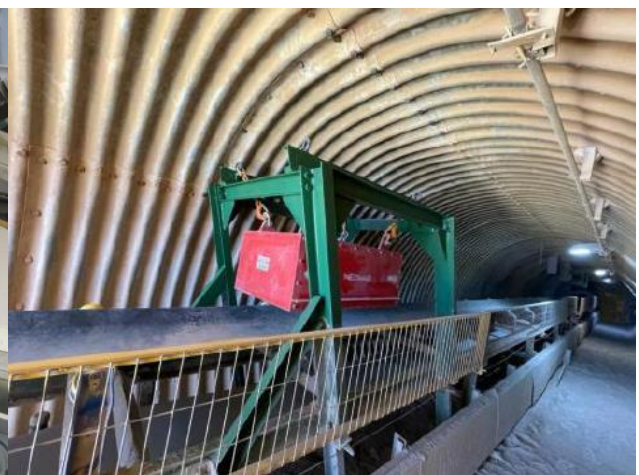
Magneto Suspendido Serie MAG, suministrados para Planta de Cal.
