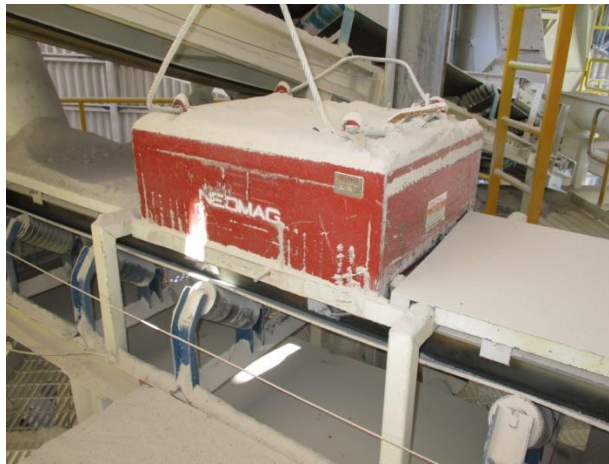
Magneto Suspendido Serie MAG, montado en su estructura parrón.
