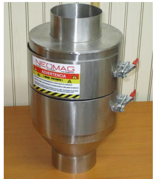
Gabinete magnético provisto de dos parrillas magnéticas.
