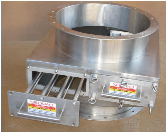
Gabinete magnético provisto de dos parrillas magnéticas, diámetro de entrada y salida 500mm.
